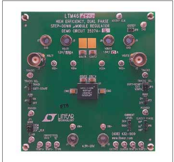
Рис. 6. Демонстрационный набор DC2527A-B для оценки модулей LTM4646
