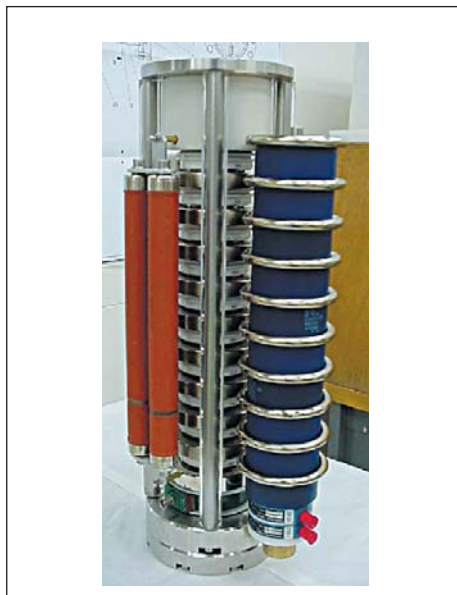
Рис. 7. Высоковольтный коммутатор, выполненный по заказу для CERN
