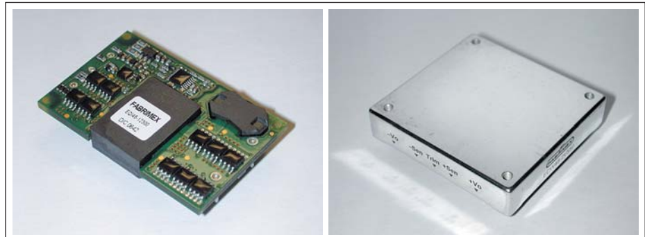
Рис. 3. DC/DC-преобразователи напряжения мощностью от 50 до 300 Вт
